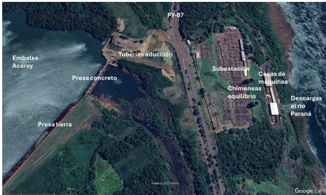
Imagen 2. Disposición de los elementos de la CHA y Presa Acaray
